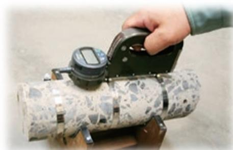
コンクリートコアの膨張量測定
