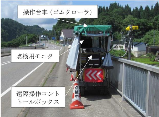
図 2-4 橋上の台車設置状況
