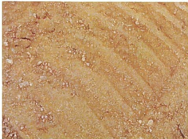
礫混じり砂質土：礫質土に比べて礫の混入量が少ない。（第3種）砂が主体で粘性土を含んだもの。手で持ってもべとつかない。ブルドーザーの転圧跡がきれいに見えるもの。
