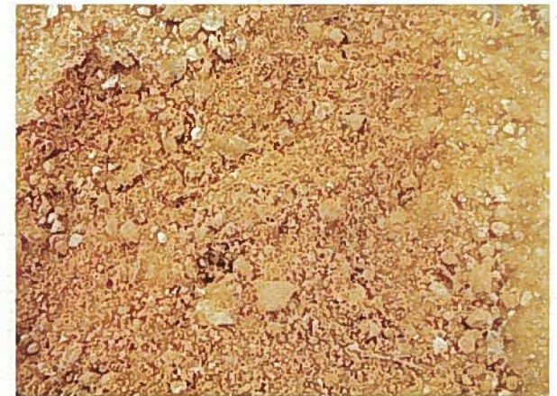
礫混じり砂質土：礫質土に比べて礫の混入量が少ない。（第3種）砂が主体で粘性土を含んだもの。手で持ってもべとつかない。
