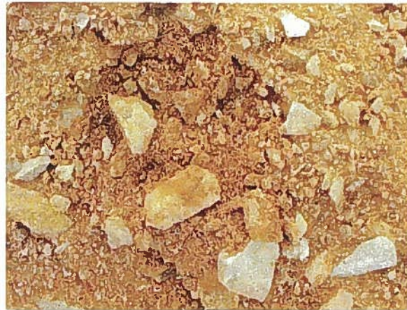
礫質土：一般に発生しやすい土砂で礫や砂。粘性土がほぼ同量混じっているもの。程度な湿り気を持っており、盛土材料としては扱いやすい。 (第2種)
