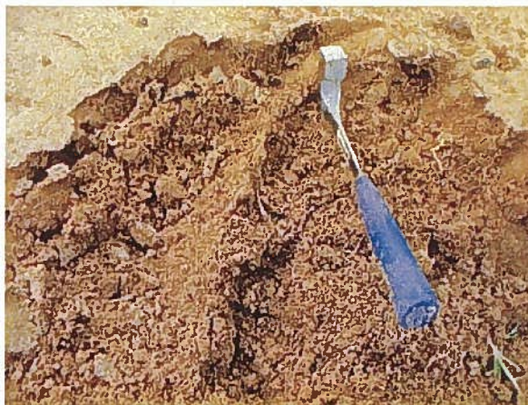
砂質土：ほとんどが砂主体で、手で持つと「さらさら」した感じ。粘性土を含む所は強く握ると固まるが、その部分が全体では少ないもの。 (第3種)
