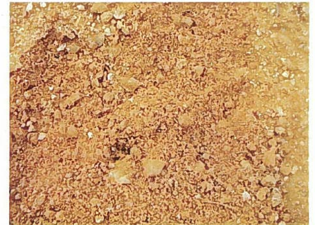
礫混じり砂質土：礫質土に比べて礫の混入量が少ない。砂が主体で粘性土を含んだもの。手で持ってもべとつかない。 (第3種)
