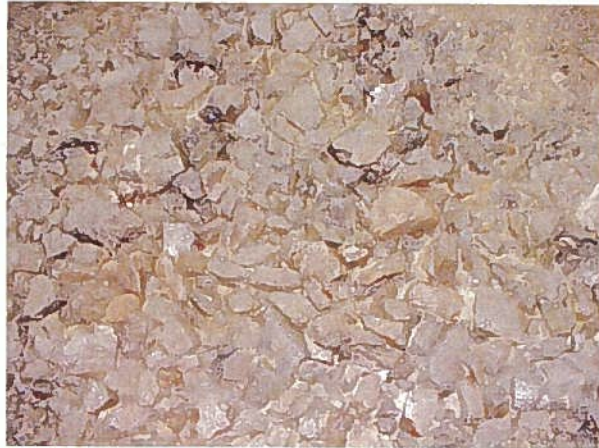
礫（碎石、ズリ）：トンネルズリや岩砕ズリの発生土で、礫主体で砂、粘性土の混入が非常に少ないもの。 (第1種)
