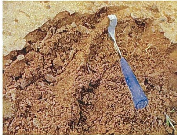
砂質土：ほとんどが砂主体で、手で持つと「さらさら」した感じ。粘性土を含む所は強く握ると固まるが、その部分が全体では少ないもの。
