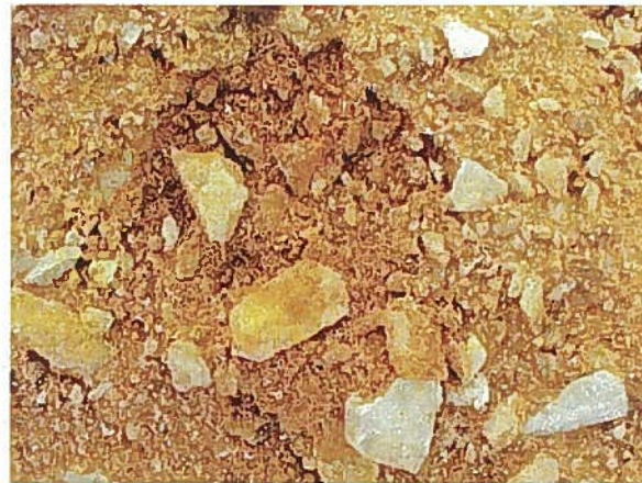
礫質土：一般に発生しやすい土砂で礫や砂。粘性土がほぼ同量混じっているもの。程度な湿り気を持っており、盛土材料としては扱いやすい。
