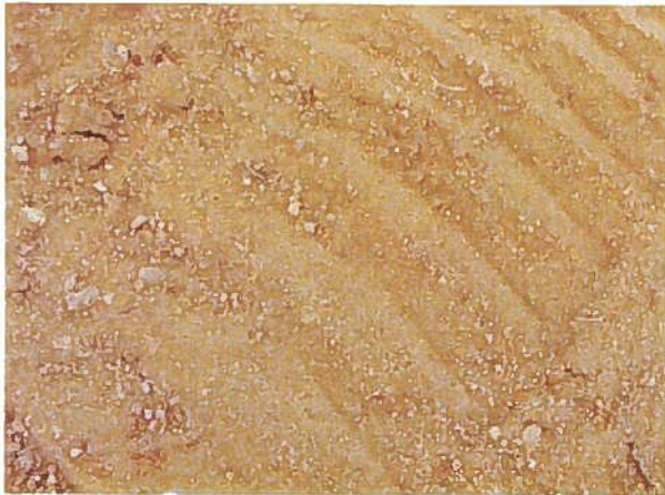
礫混じり砂質土：礫質土に比べて礫の混入量が少ない。砂が主体で粘性土を含んだもの。手で持ってもべとつかない。ブルの転圧跡がきれいに見えるもの。 (第3種)
